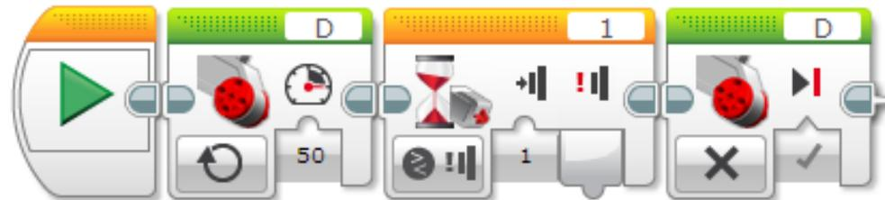
In questo programma, il motore gira fino a quando non viene premuto un sensore di contatto, e poi si ferma.
