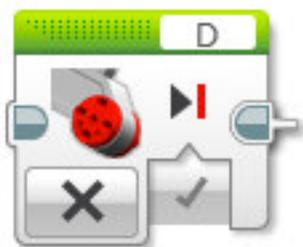
Se il **Brake at End** è True, il motore si ferma immediatamente.
