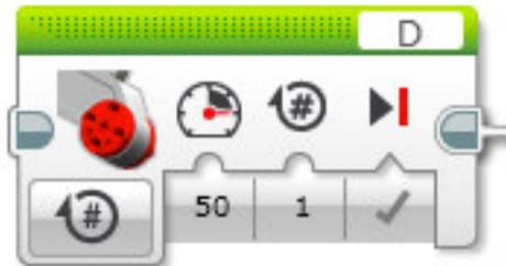
Il motore girerà per il numero di rotazioni specificato in ingresso, poi si spegne. È possibile controllare la velocità e la direzione del motore specificando la potenza.
