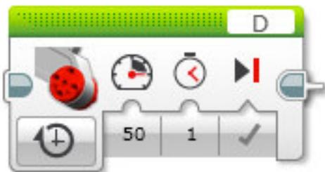
Il motore girerà per il numero di secondi specificato in ingresso, poi si spegne. È possibile controllare la velocità e la direzione del motore specificando la potenza. Settando a True il **Brake at End** il motore si arresterà esattamente dopo i secondi specificati.
