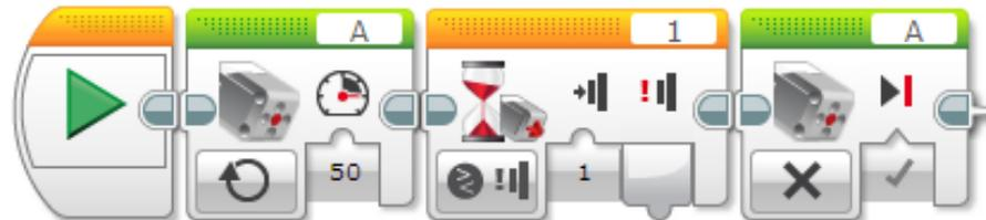
In questo programma, il motore gira a metà potenza fino a quando non viene attivato il sensore di contatto, e poi si ferma.
