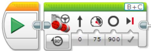
Questo programma farà andare in avanti il robot al 75% della potenza e per 900 gradi (due rotazioni e mezzo), poi si ferma. (**Brake at End** è True)
