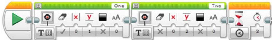
Questo programma visualizza due linee di testo. Il secondo Display Block usa False per **Clear Screen** input e aggiunge la seconda linea senza cancellare la prima.
