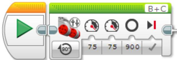
Questo programma farà andare in avanti il robot al 75% della potenza e per 900 gradi (due rotazioni e mezzo), poi si ferma. (Brake at End è True)
