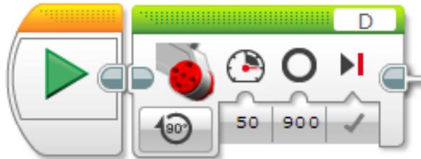
Questo programma azionerà il motore sulla porta A con il 50% di potenza per esattamente 900 gradi (due rotazioni e mezzo), e poi lo ferma istantaneamente (**Brake at End** è True)
