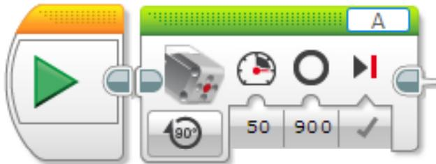
Questo programma azionerà il motore sulla porta A con il 50% di potenza per esattamente 900 gradi (due rotazioni e mezzo), e poi lo ferma istantaneamente (Brake at End è True)
